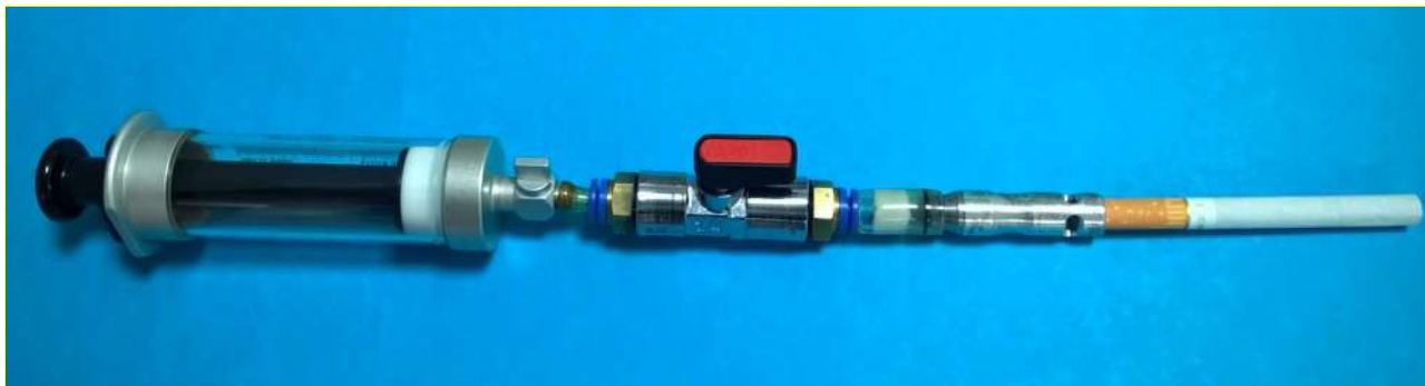
Figura 2: sistema di campionamento del fumo di sigaretta
