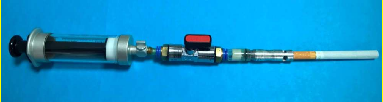
Figura 2: sistema di campionamento del fumo di sigaretta
